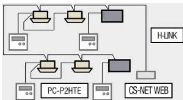
Vnitřní a venkovní jednotky též mezi sebou se propojují jen 2 vodiči. Hitachi to nazývá "**H-LINK**". Všechny klimatizační jednotky se propojí jakkoliv v sérii mezi sebou. Výhody tohoto propojení pak jsou:
